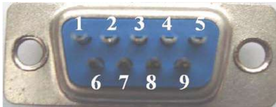
DB9 FÊMEA PARTE TRASEIRA PONTOS PARA SOLDA
