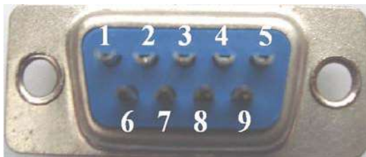
DB9 FÊMEA PARTE TRASEIRA PONTOS PARA SOLDA
