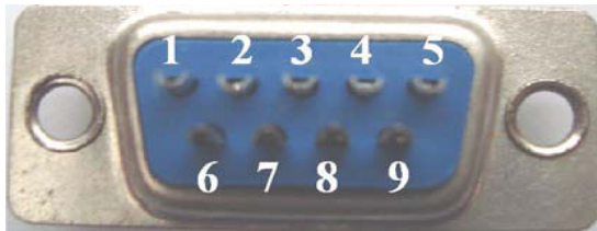
DB9 FÊMEA PARTE TRASEIRA PONTOS PARA SOLDA
